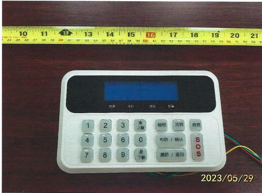
图三、SS-200V3 中文液晶显示键盘外部结构
