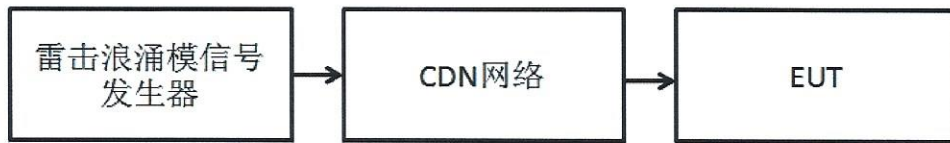
图十九、浪涌（冲击）抗扰度试验测试配置示意图
