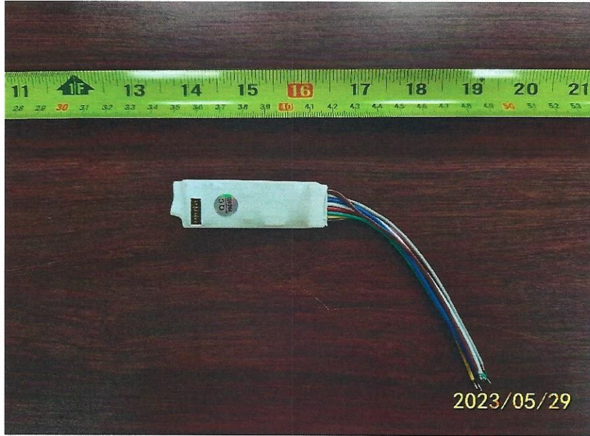
图十一、SS-811 单防区扩展带一路输出模块外部结构
