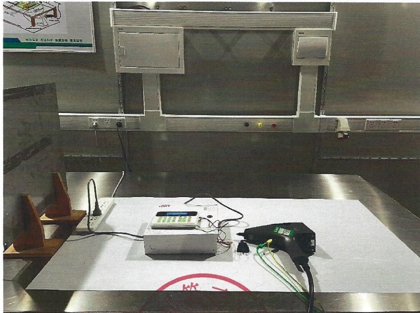
图十六、静电放电抗扰度试验现场照
