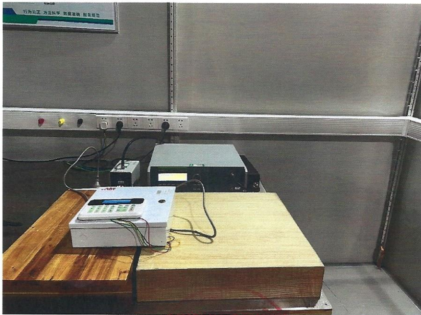
图二十四、射频场感应的传导抗扰度试验现场照
