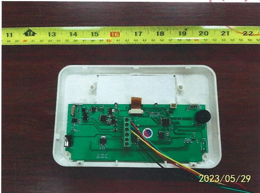
图四、SS-200V3 中文液晶显示键盘内部结构
