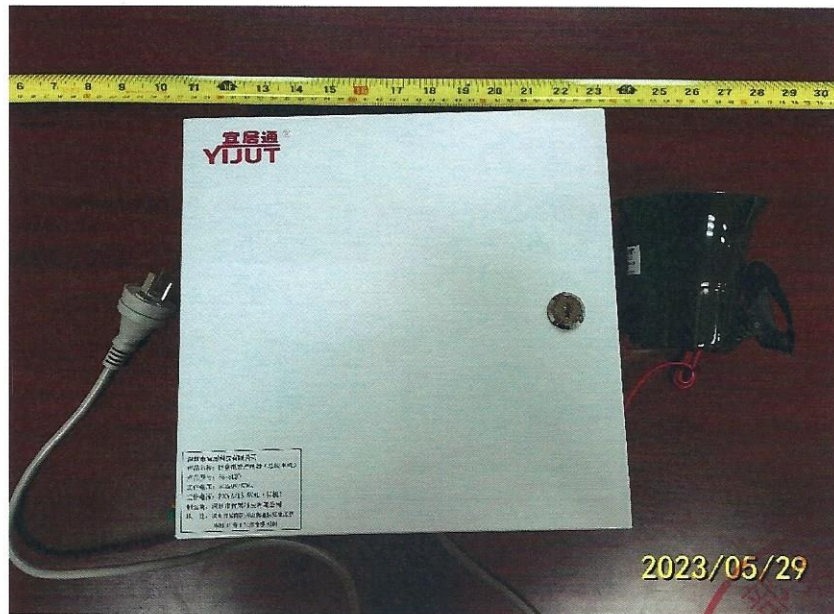
图一、SS-8120 防盗报警控制器外部结构
